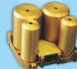
czujnik do pomiaru temperatury i przewodnictwa cieplnego (THP) opracowany i wykonany w Centrum Badań Kosmicznych PAN
