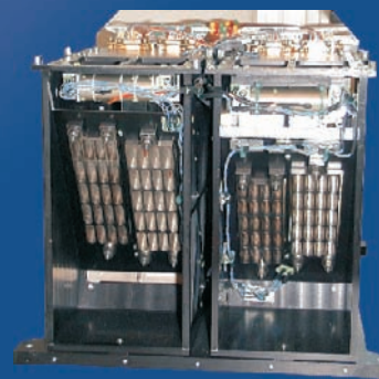
Spektrometr rentgenowski RESIK. Widok od strony detektorów.
